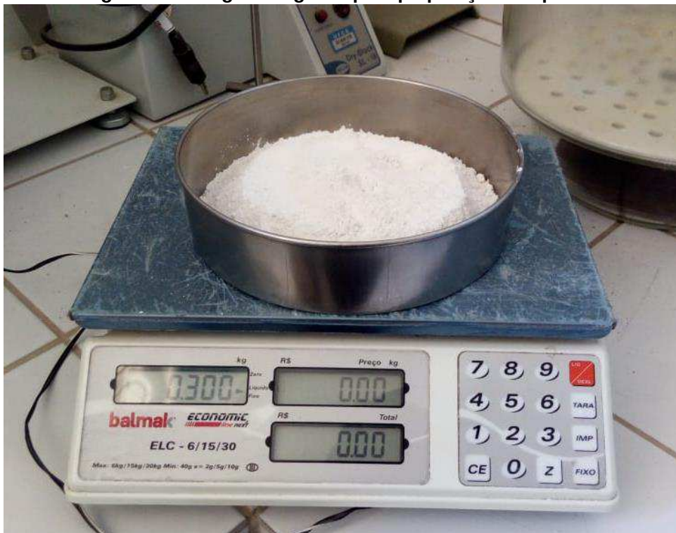
Figura 5 – Pesagem do gesso para preparação das pastas
