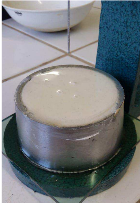
Figura 15 – Exsudação da água com aditivo
