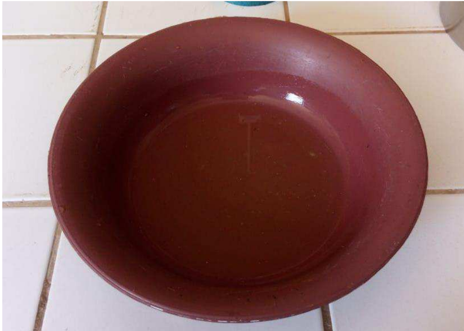
Figura 9 – Adição de 10% do caldo da cana de açúcar incorporado à água de amassamento
