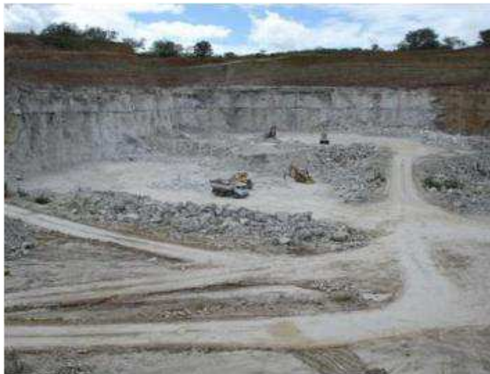
Figura 2 - Frente de lavra de gipsita no Pólo Gesseiro do Araripe
