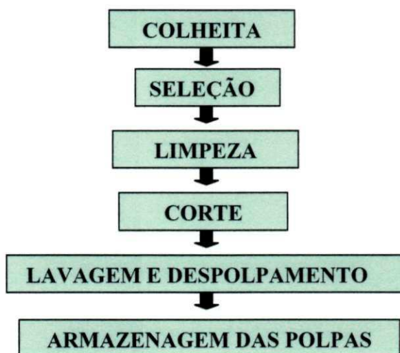
Figura 3.1. Fluxograma das operações para preparação das polpas do facheiro
