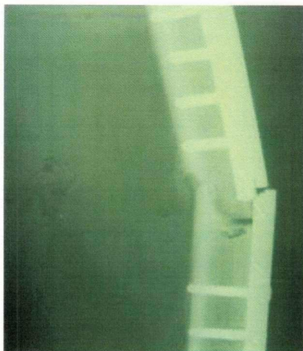
Figura 3. Fratura de placa metálica do fêmur.
