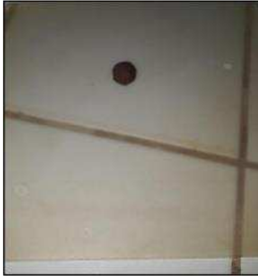
Figura 5: vidro esmerilhado utilizado como base para o ensaio de limite de plasticidade.
