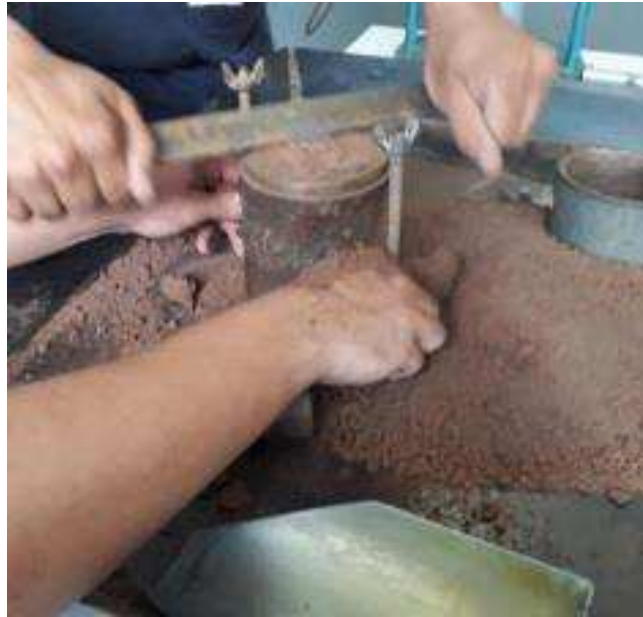
Figura 9: Processo de nivelamento do solo compactado.
