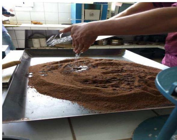
Figura 10: Ensaio de CBR - a) adição de água a amostra de solo, b) homogeneização do solo com a água, c) compactação da amostra, d) imersão do corpo-de-prova.
