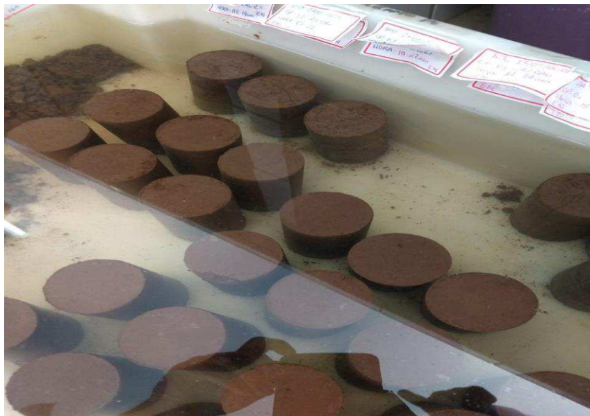
Figura 14: corpos de prova imersos em água por 24 horas
