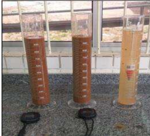
Figura 3: Provetas utilizadas no ensaio de granulometria do solo.
