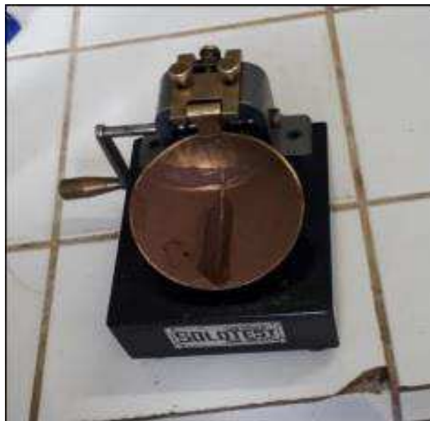
Figura 4: aparelho de Casagrande, contendo amostra, usado para realizar o ensaio de limite de liquidez.
