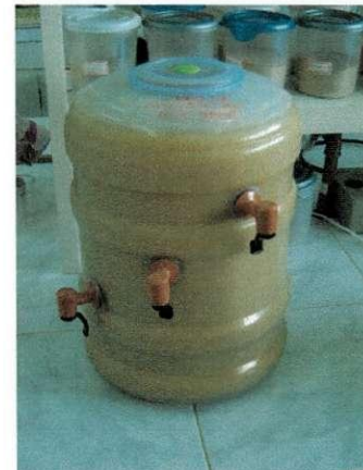
Figura 15 – Reservatório de decantação
