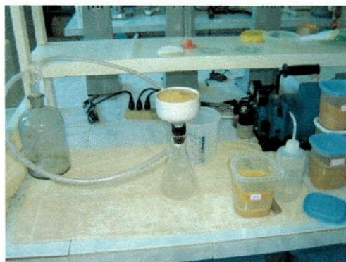
Figura 18 – Equipamento de filtração
