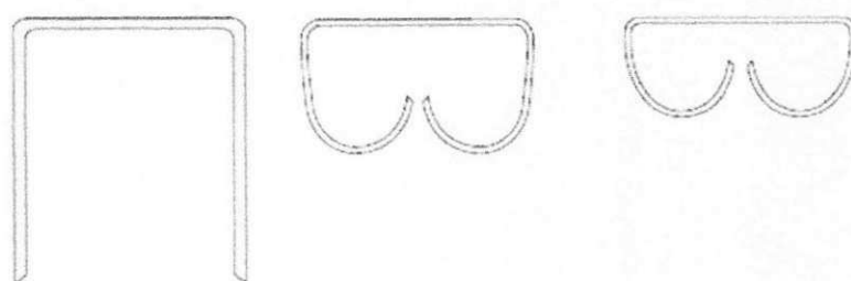
Figura 3 - Configurações aberta e fechada de grampos utilizados para aproximar tecidos internos.
