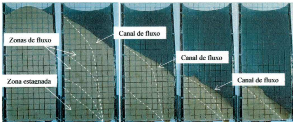
Figura 52. Sequência de imagens para o fundo plano orifício 03
