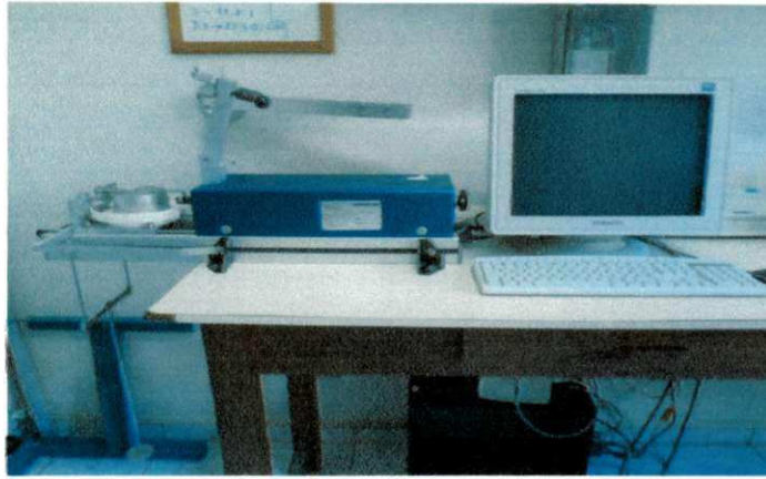
Figura 27. Ensaio para determinação das propriedades de fluxo
