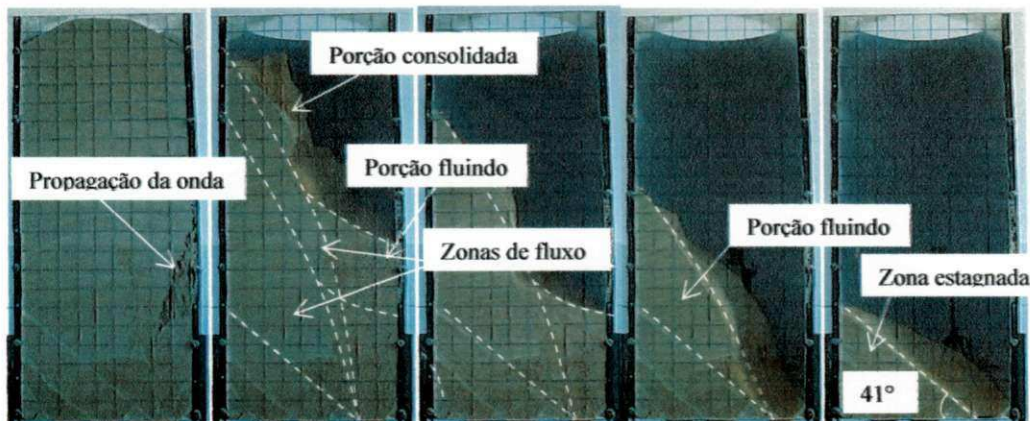
Figura 48. Sequência de imagens para o fundo plano orifício 03
