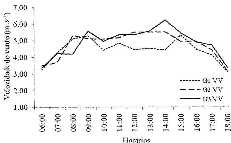
Figura 12. Valores da velocidade do vento (VV), em função dos horários nos diferentes galpões e horários
