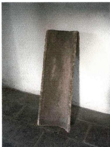
Figuras 30 b – Telha de cerâmica, manual. (canal)
