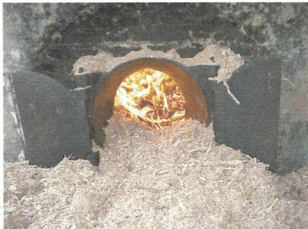
Figura 84 – Porta de alimentação em ferro fundido do Engenho Bujari
