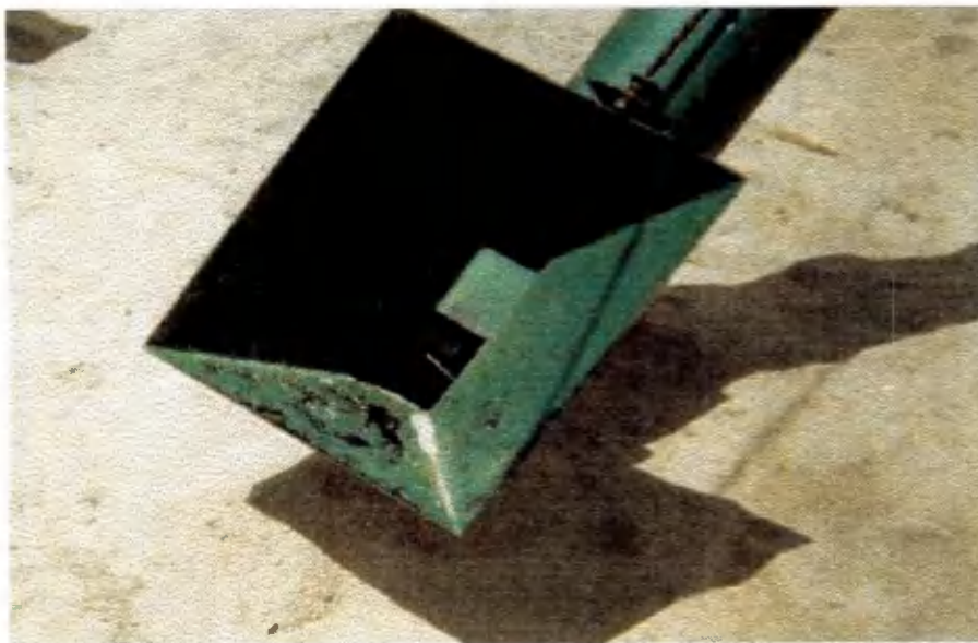
FIGURA 09 - Abertura da rosca transportadora
