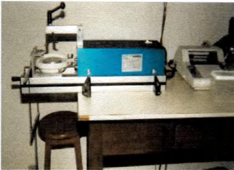
FIGURA 14 - Máquina para ensaio de cisalhamento (Jenike Shear Cell)
