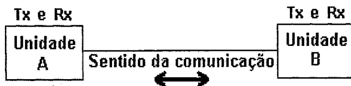
Figura 2.3: Diagrama em blocos do modo de comunicação half-duplex .
