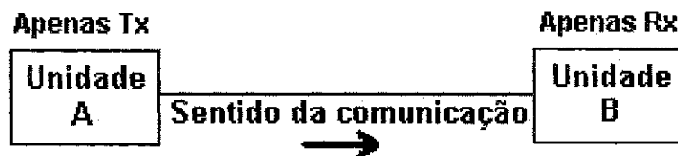
Figura 2.2: Diagrama em blocos do modo de comunicação simplex .
