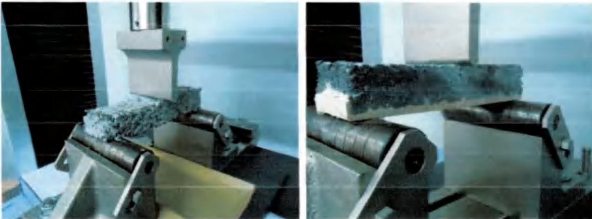
Figura 4.13 Esquema do ensaio de flexão em três pontos na placa e no novo compósito.
