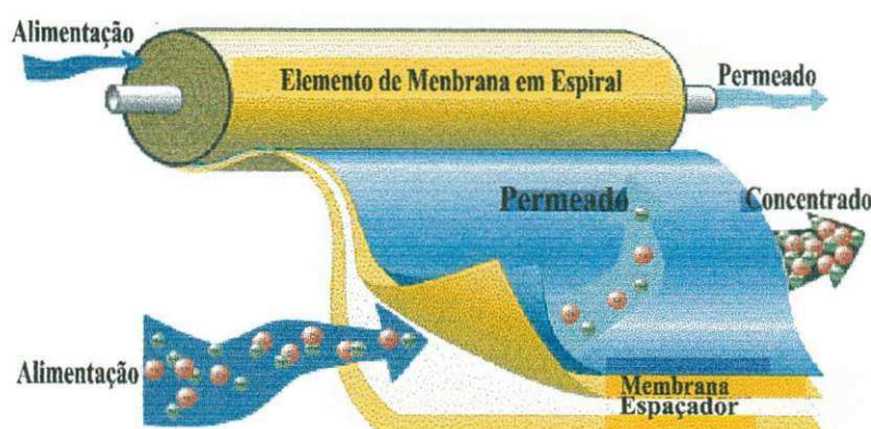
Figura 2.3: Elemento de membrana em espiral para o processo de osmose inversa (Silveira, 1999).
