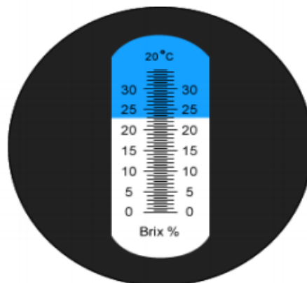
Figura 5. Leitura do Refratômetro em escala Brix
