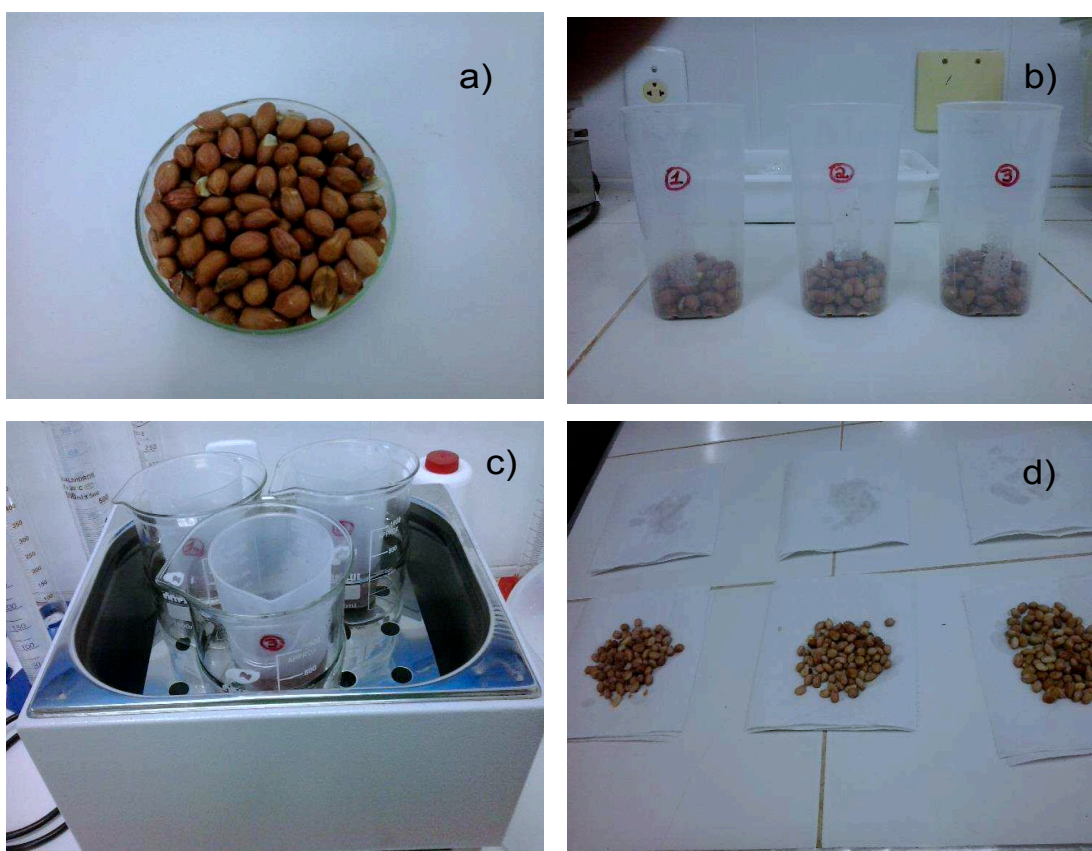
Figura 3 - Processo de hidratação dos grãos de amendoim: (a) amostras, (b) reatores para reidratação, (c) banho termostático e (d) drenagem dos grãos
