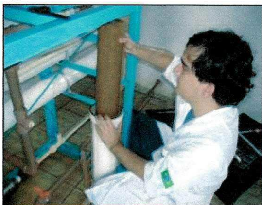
Figura 17 - Troca de filtros
