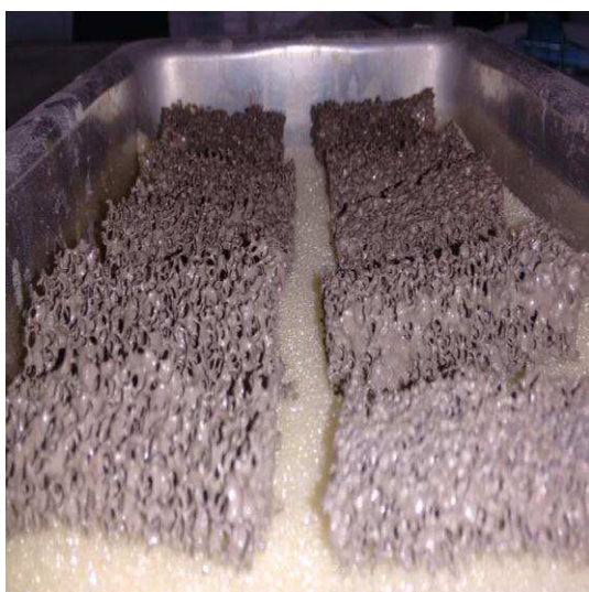
Figura 3.5- Suspensão cerâmica impregnada na espuma polimérica.
