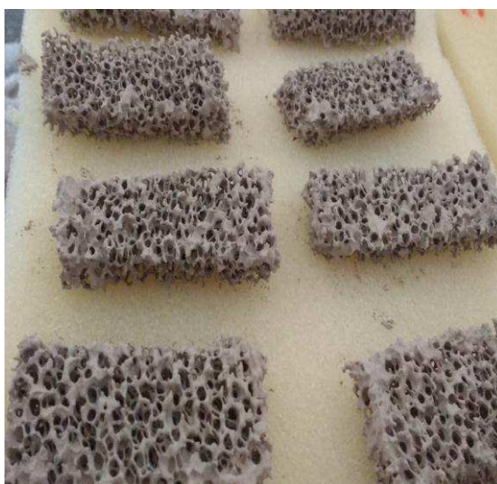
Figura 3.6 - Espuma cerâmica após secagem em estufa 110°C
