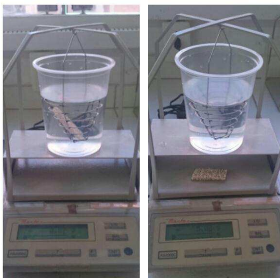
Figura 3.9- Medição do peso seco, peso úmido e peso imerso das espumas cerâmicas.
