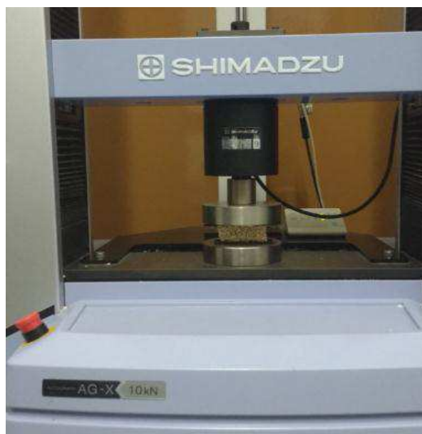
Figura 3.11- Ensaio de compressão
