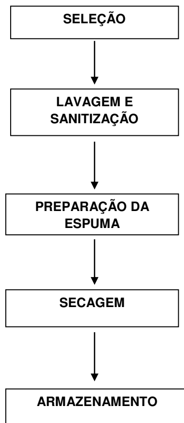
FIGURA 4.1 – Fluxograma básico do processamento dos frutos para obtenção da secagem da acerola pelo método foam-mat.
