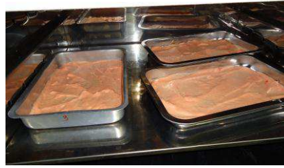
Figura 5.3 Bandejas centralizadas na estufa de circulação para secagem
