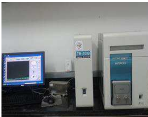
Figura 20 – Equipamento HITACHI TM 1.000 para avaliação-MEV
