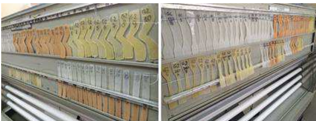
Figura 19 – Disposição dos corpos de prova (prateleiras) dentro da câmara de envelhecimento acelerado
