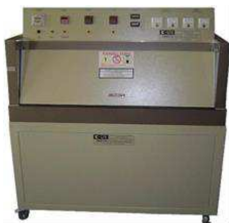
Figura 18 – Câmara de envelhecimento acelerado para não-metálicos C-UV. (Comexim – NBR 9512)
