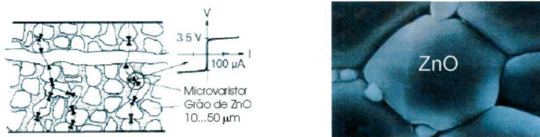
Figura 1.7 – Detalhes microscópicos do varistor de ZnO (Steinfeld, 2002).
