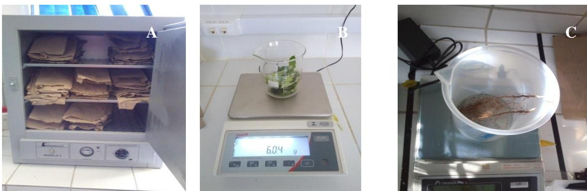
**Figura 4.** Material posto para secar em estufa (A), pesagem da fitomassa seca de folhas (B), e pesagem da fitomassa seca de raiz (C).
