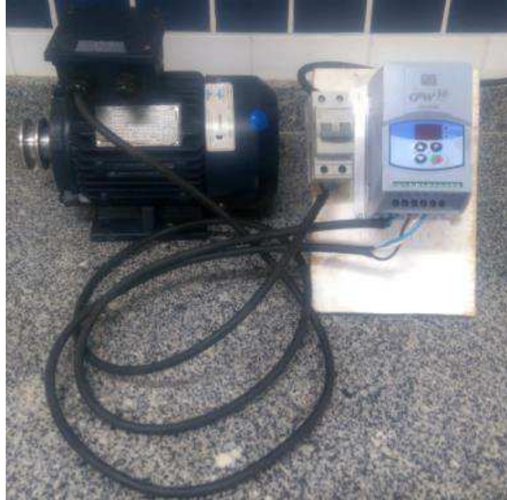
Motor conectado ao inversor de frequência
