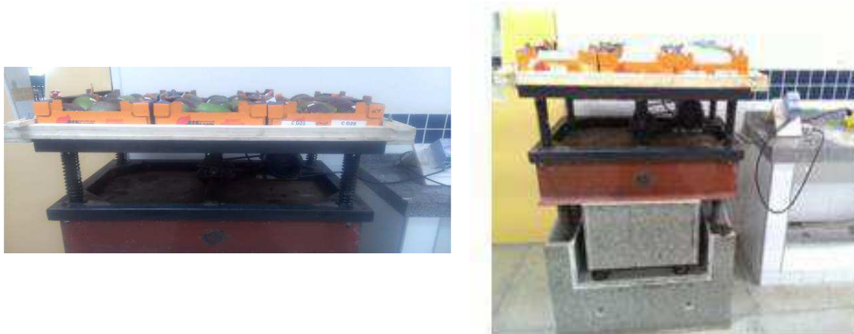
Figura 3.11 – Máquina de vibração com caixas tipo exportação contendo mangas ‘Palmer’ (A) e conjunto máquina e banca de inércia (B) utilizado nos ensaios experimentais.
