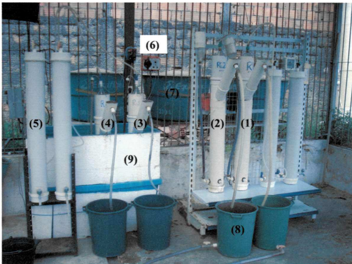
Figura 4.2: Fotografia do sistema monitorado: (1,2,3 e 4) respectivos reatores UASB R 1 , R 2 , R 3 e R 4 , (5) Mariottie com NaOH 3%, (6) bomba dosadora de alimentação (7) caixas de armazenamento do vinhoto afluente, (8) baldes de coleta e armazenamento do efluente, (9) tanque com água a 37°C, (10) dispositivo de entrada do afluente.
