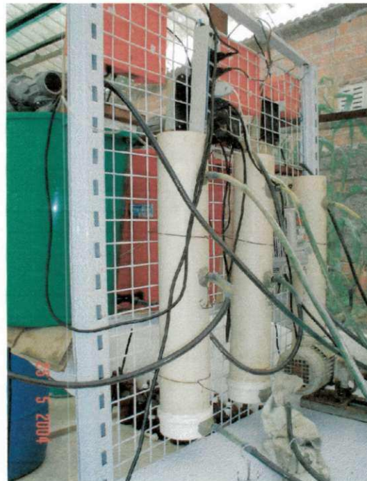
Figura 3.3 – Decantadores utilizados nos reatores R_1 , R_2 e R_3 , respectivamente.
