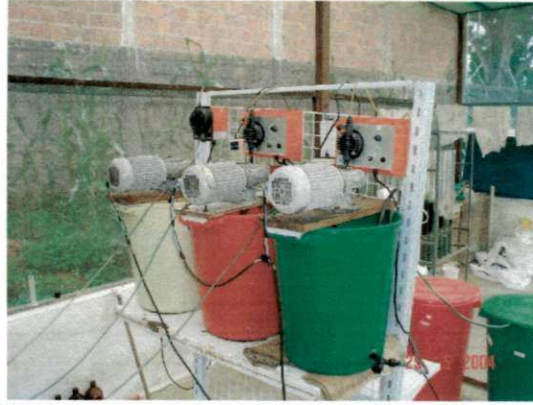
Figura 3.4 – Sistemas experimentais de lodos ativados (R 1 , R 2 e R 3 ).
