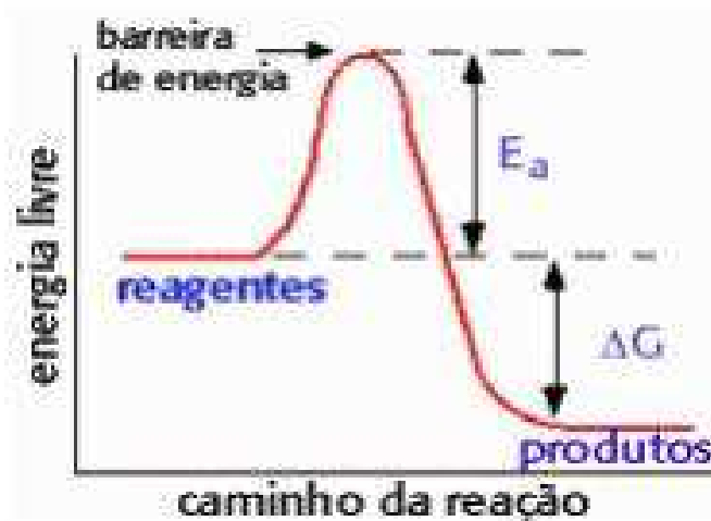
Figura 14: Energia de ativação com a barreira que separa os produtos dos reagentes.
