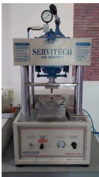
**Figura 2** - Prensa utilizada para conformação dos corpos de prova.
