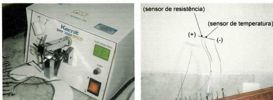
Fig. 45 – Máquina de soldagem Kernit SMP 3000 Gold e fita Ti-Ni-Cu \pm 24,5 mg em teste de 4 pontos
