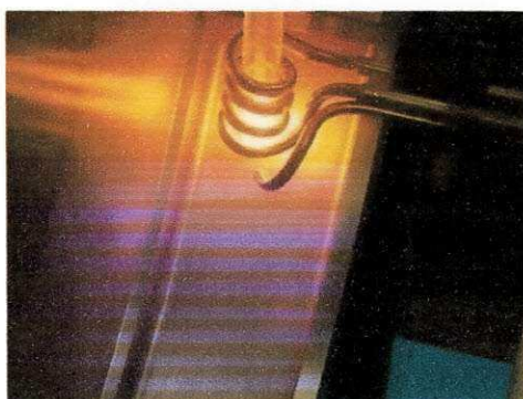
Fig. 29 – Foto ilustrativa de um equipamento Melt Spinning 2 em funcionamento
