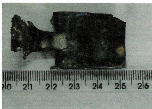
Fig. 39 – Porção da liga Ti_{45}Ni_{48}Cu_7 obtida por fundição, utilizando a máquina Discovery All
