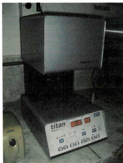
Fig. 32 – Equipamento Platinum usada para efeito de tratamento térmico
