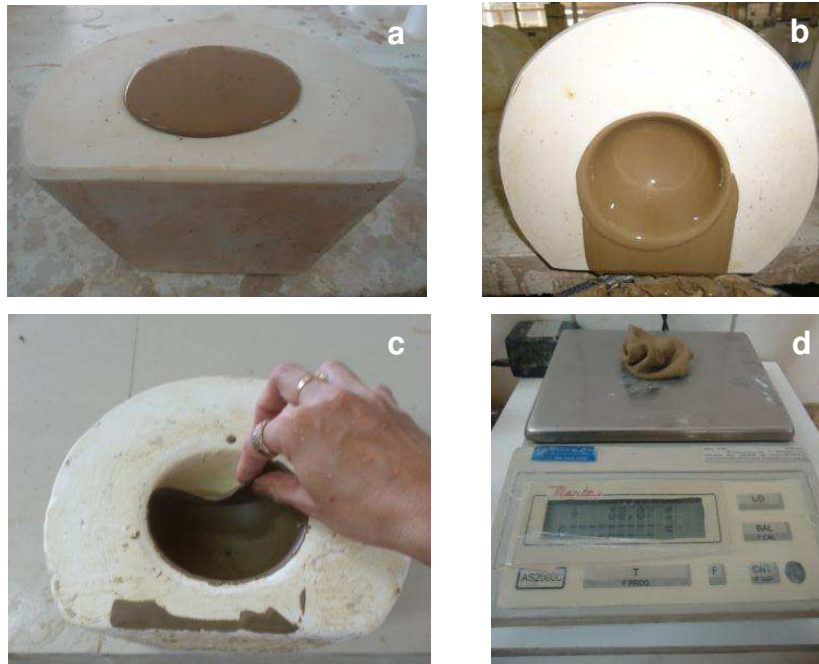
Figura 4.6 – Determinação da velocidade de deposição da barbotina: (a) preenchimento, (b) escorrimento, (c) destacamento, (d) pesagem Fonte: Arquivo Pessoal, (2014).
