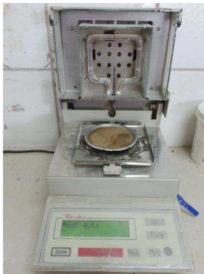
Figura 4.5 – Determinação do resíduo de moagem da barbotina Fonte: Arquivo Pessoal, (2014).
