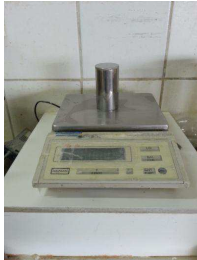
Figura 4.4: Determinação da densidade por meio de um densímetro Fonte: Arquivo pessoal, (2014).
