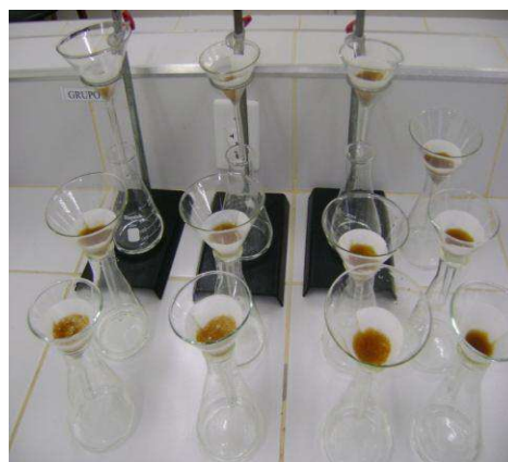
Figura 11 – Processo de Filtração da Resina Fonte: Dados da Pesquisa
