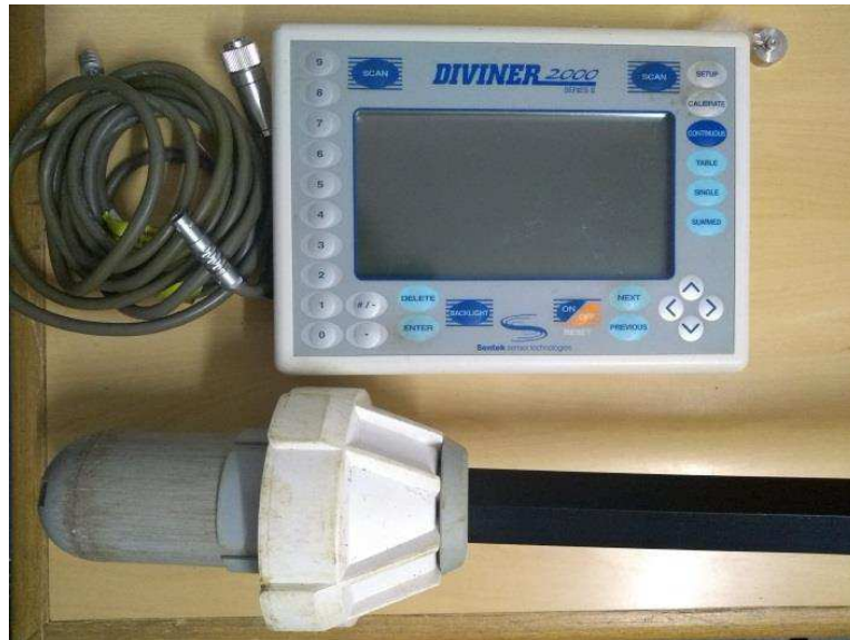
Figura 4 – Equipamento completo de medição da umidade do solo, modelo Diviner 2000, com datalogger, cabo de conexão e sensor.
