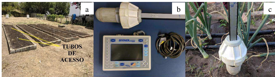
Figura 5. Monitoramento da umidade do solo, a) Tubos de acesso por canteiro, b) sonda Diviner para o monitoramento de umidade, c) Sonda monitorando a umidade do solo.
