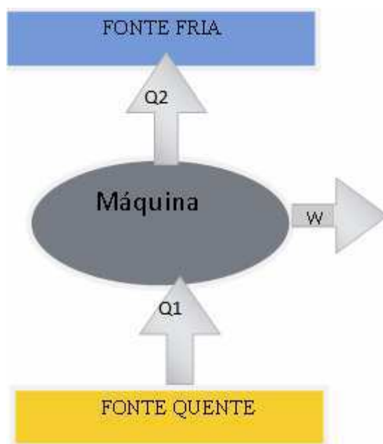
Figura 3 – Estrutura de uma máquina térmica.
