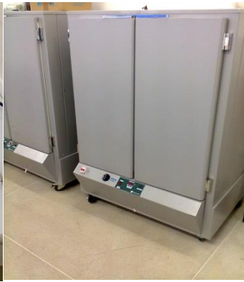
Estufa de ventilação forçada
