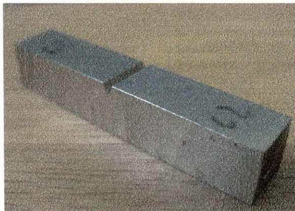
Figura 3.13 – Fotografia de um corpo de prova Charpy.
