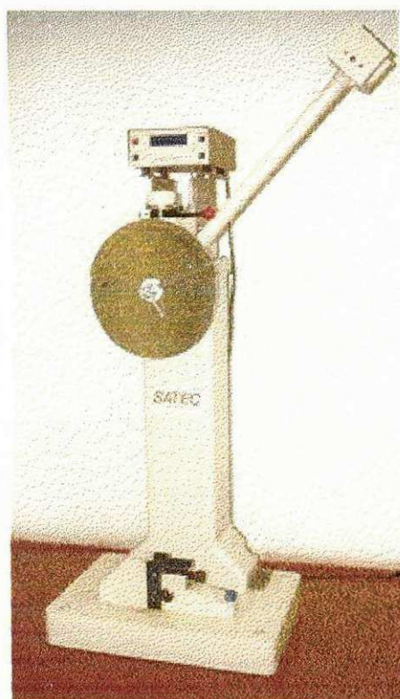
Figura 2.15 – Fotografia de máquina de ensaio Charpy.
