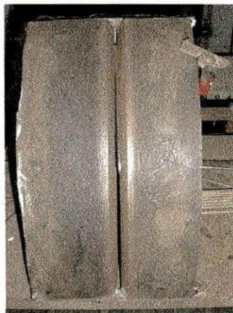
Figura 3.4 – Fotografia de peça usinada com chanfro em V, para posterior soldagem.
