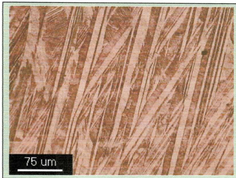
FIGURA 3.6 – Plaquetas de martensitas em grupos de auto-acomodação em “V” na liga Cu-Al-Ni-0,6Mn (composição em peso).
