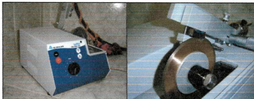
FIGURA 4.16 – Cortadeira metalográfica para a obtenção de lâminas LMF.
