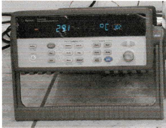
FIGURA 4.7 – Sistema de aquisição de dados com módulo multiplexador de 20 canais.
