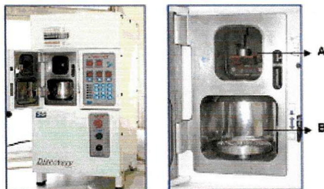
FIGURA 4.14 - Máquina de fusão a plasma Discovery All, da EDG Equipamentos e Controles, com detalhes das câmaras (A - Câmara Superior – Fusão / B- Câmara Inferior – Conformação).
