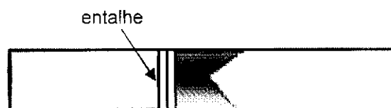
Figura 12: Junta soldada em K. Fonte: Anderson (1995).
