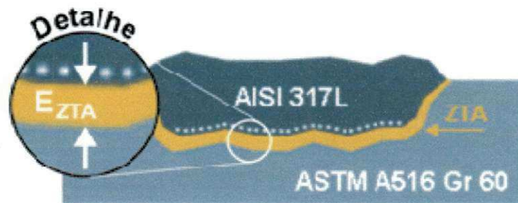
Figura 25: Disposição das impressões de microdureza ao longo da interface revestimento/substrato.
