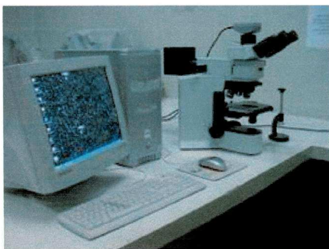
Figura 20: Microscópio óptico acoplado a um computador.
