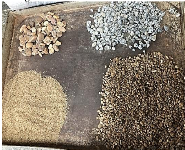
Figura 4 – Materiais do sistema filtrante
