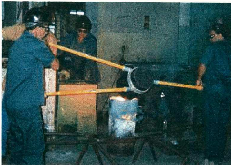
Fig.3.7 – Processo de nodulização na transferência do metal líquido da panela de transferência para a panela intermediária (panela de nodulização).
