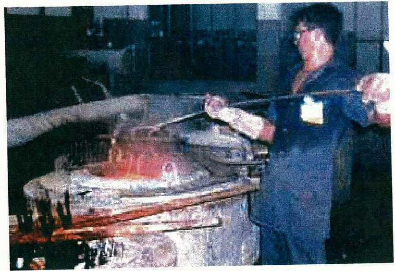
Figura 3.11 - Forno elétrico usado no tratamento térmico de austenitização dos corpos de prova de fadiga.
