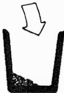
Figura 2.11 – Processo de nodulização por simples transferência, [20].
