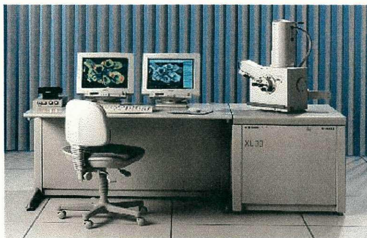
Fig. 3.16 – Microscópio Eletrônico de Varredura utilizado nas análises microestrutural e de superfície de fratura dos corpos de prova de fadiga.
