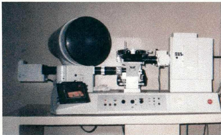
Figura 3.17 - Microscópio óptico ECRAN usado na análise morfológica dos nódulos de grafita dos corpos de prova de fadiga.
