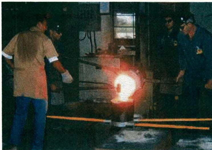
Fig. 3.8 – Processo de inoculação (despejo na bica) do FeSi75A na transferência do metal líquido da panela de nodulização para a panela de despejo.
