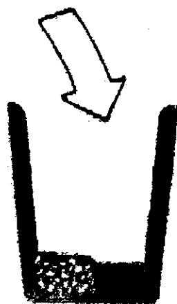
Figura 2.12 – Processo de nodulização sandwich de ligas de magnésio, [20].
