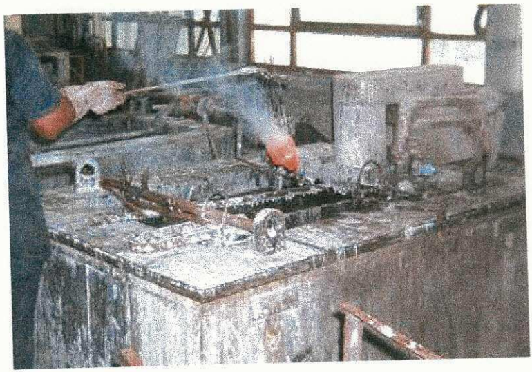
Figura 3.12 - Forno elétrico usado no tratamento isotérmico de austêmpera dos corpos de prova de fadiga.
