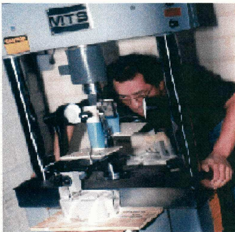
Figura 3.14 – Acompanhamento visual do crescimento da trinca de fadiga através do “ Travel Microscope ” auxiliado pela iluminação direcionada do “ spot-light ”.
