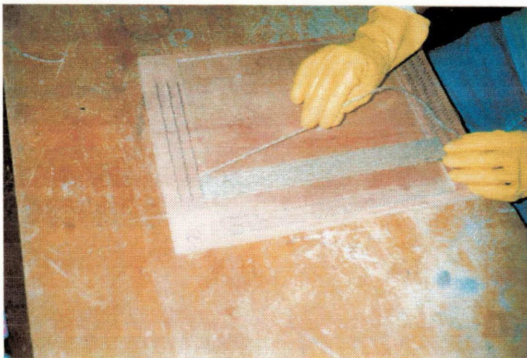
Figura 13 - Tábua usada para o alinhamento dos cordões.
