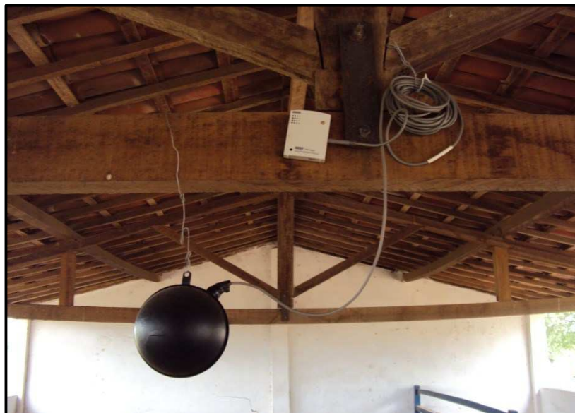
FIGURA 3 – Datalogger tipo HOBOT com cabo externo acoplado ao globo negro. Fonte: Alves, A. S.
