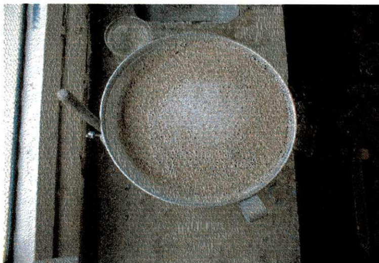
FIGURA 3.3 – Detalhes do funil no ensaio de determinação do teor de vermiculita.
