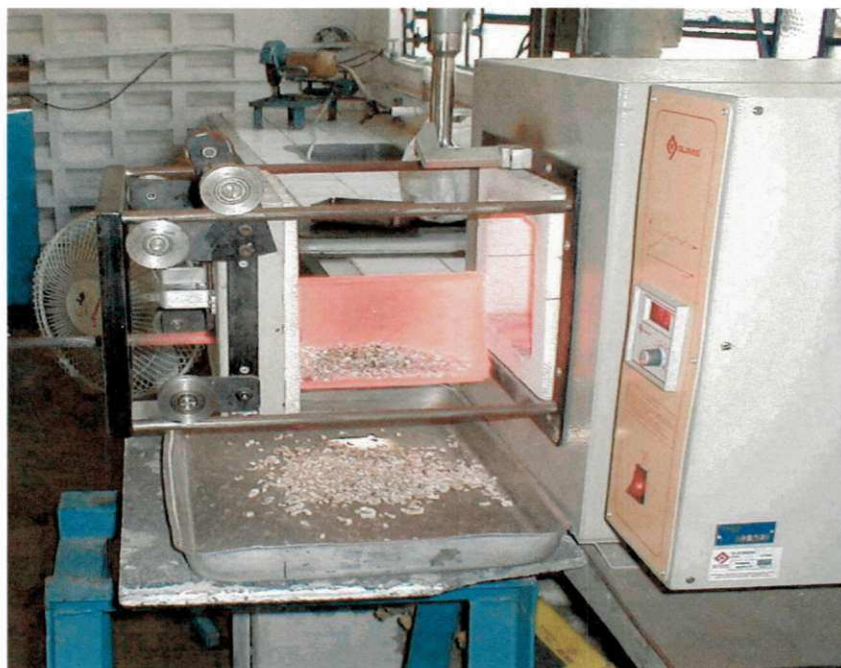
FIGURA 3.1 - Detalhes da mufla e acessórios utilizados na realização de um ensaio de esfoliação de vermiculita.
