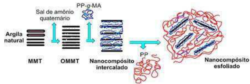
Figura 3.2. Esquema de preparação dos nanocompósitos PP/MMT (Fonte: Elaborada pelo autor)
