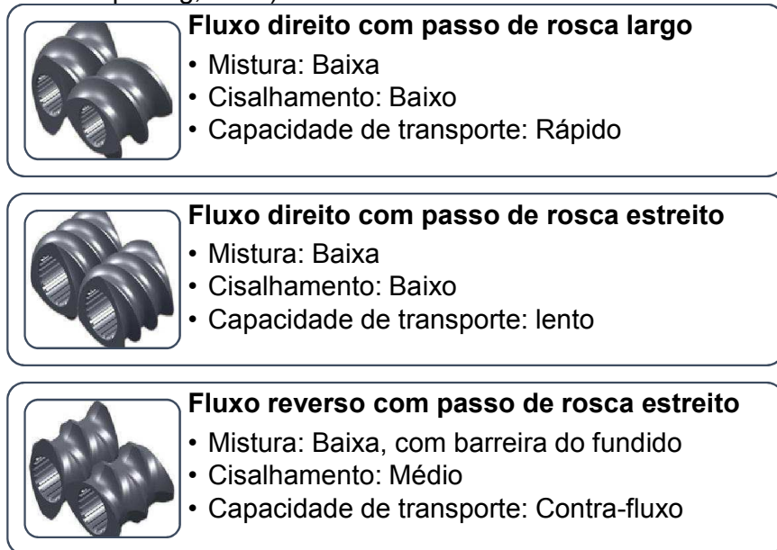
Figura 3.14. Principais características de alguns elementos de condução (adaptado de Sperling, 1997)
