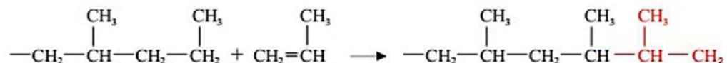
Figura 3.5. Adição irregular "cabeça-cabeça" de uma unidade estrutural a uma cadeia de PP (adaptado de Alves, 2012)
