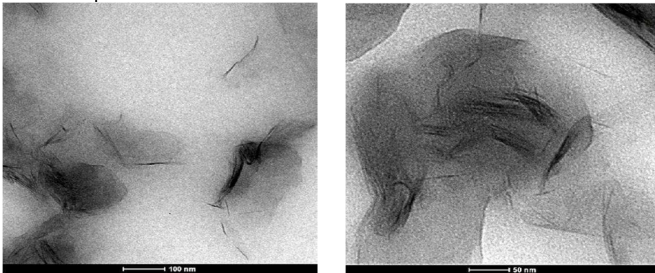
Figura 6.20. Fotomicrografias de MET da amostra PP/5gMA/5A/05Eru. Escala: 100 e 50nm respectivamente.
