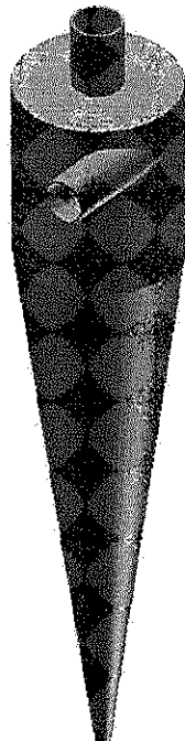
Figura 8 - Hidrociclone feito no DesignModeler®
