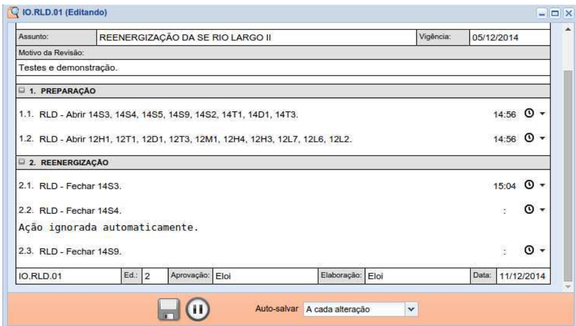
Figura 4.11: Visão do operador durante a execução da manobra de recomposição da SE RLD.
