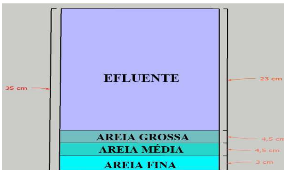
Figura 4: modelo esquemático do filtro de areia.
