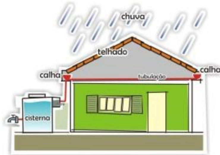
Figura 2 - Sistema de coleta de água da chuva
