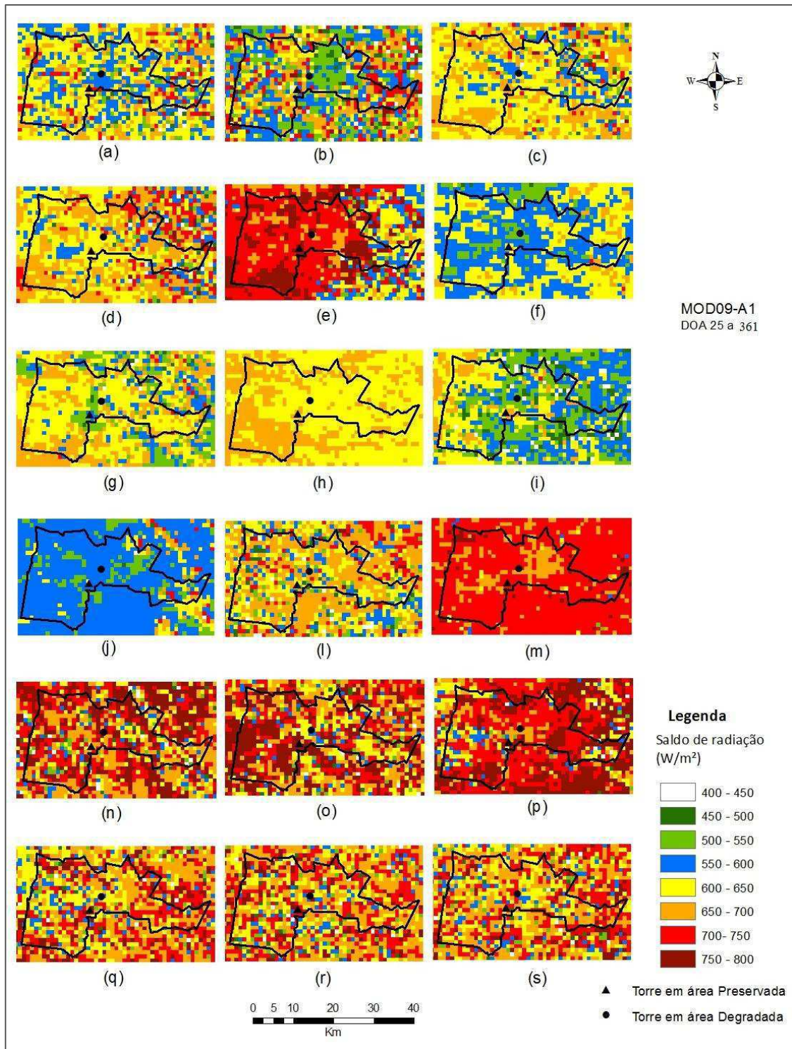
Figura 14. Mapa do saldo radiativo, obtido utilizando o albedo calculado a partir do produto MOD09-A1, para o município de Campina Grande, referente aos dias de ordem do ano: 25 (a), 33 (b), 57 (c), 65 (d), 81 (e), 105 (f), 137 (g), 169 (h), 193 (i), 209 (j), 217 (l), 233 (m), 249 (n), 281 (o), 289 (p), 313 (q), 329 (r) e 361 (s).
