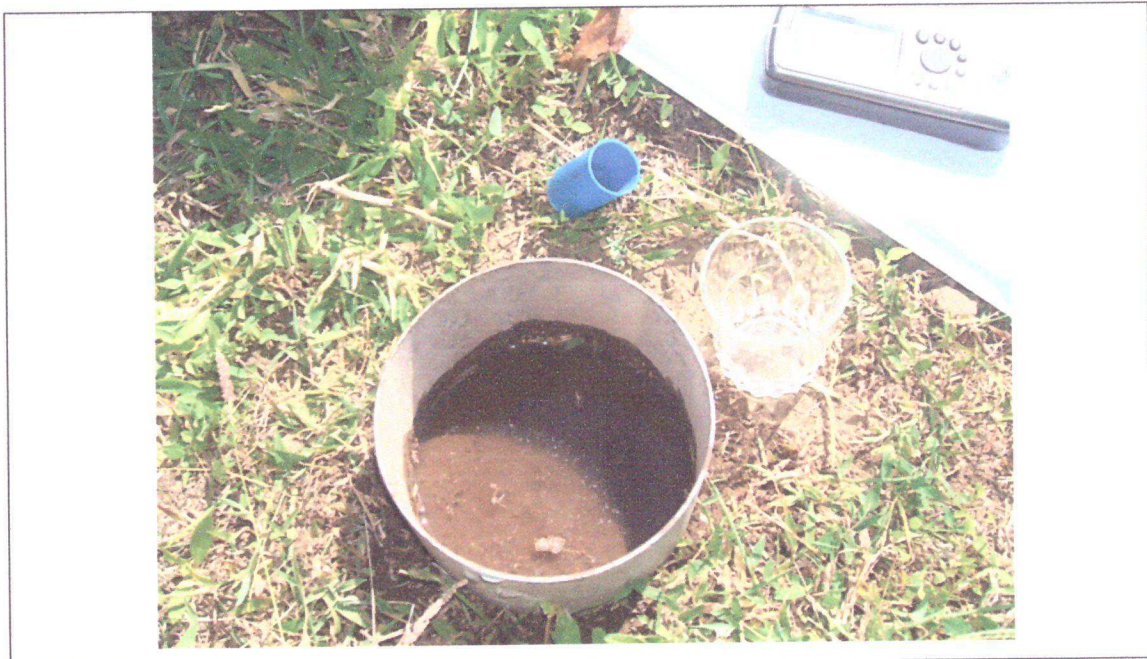
Figura 8. Cilindro infiltrômetro usado na determinação de infiltração de água no solo. UFCG/CCTA/UAGRA. Pombal, PB, 2010.
