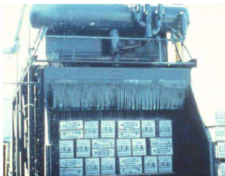
Figura 2.6: Túnel de hidrorresfriamento de alimentos por banho de água fria. Fonte: Fennema et al. (2010)
