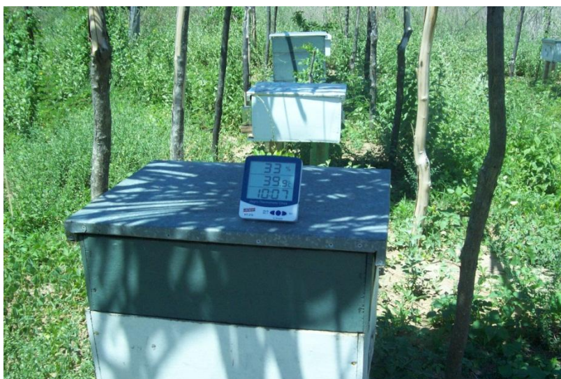
Figura 2 - Leitura da temperatura e umidade relativa do ar utilizando um termohigrômetro digital.
